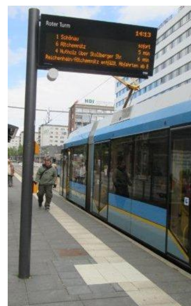
Abbildung 7: Dynamische Fahrgastinformation mit Sprachausgabe, eingebunden in taktiles Leitsystem
